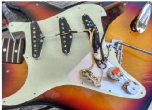
4. Entferne nun den mittleren Anschluss des Volume-Potis und verbinde dieses Kabel mit dem gelben Kabel des S.R.Visionizers. Zur Isolation der Lötstelle liegt dem Einbau-Set ein Stück Schumpfschlauch bei.
