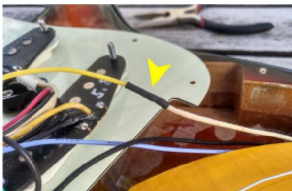
5. Löte das grüne Kabel des S.R.Visionizers an den freien, mittleren Anschluss des Volume-Potis.
